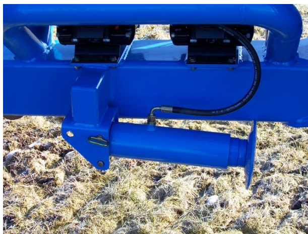
PTW 8500 л Гидр. опорная нога
