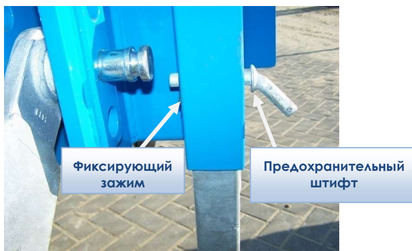
Опорные подставки под инжектором Ликвилайзера
