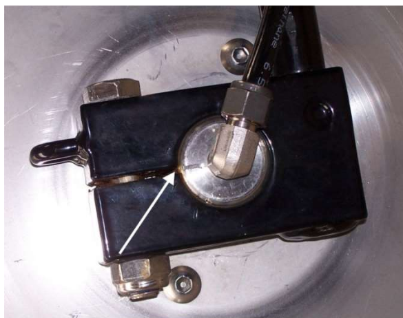
Зажимный блок на ињекционном колесе. Регулировка места ињекции.
