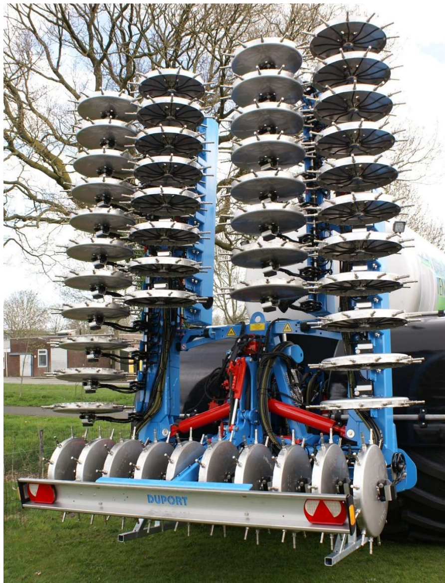
Ликвилайзер SW12048 прицеплен к навесной системы бочки
