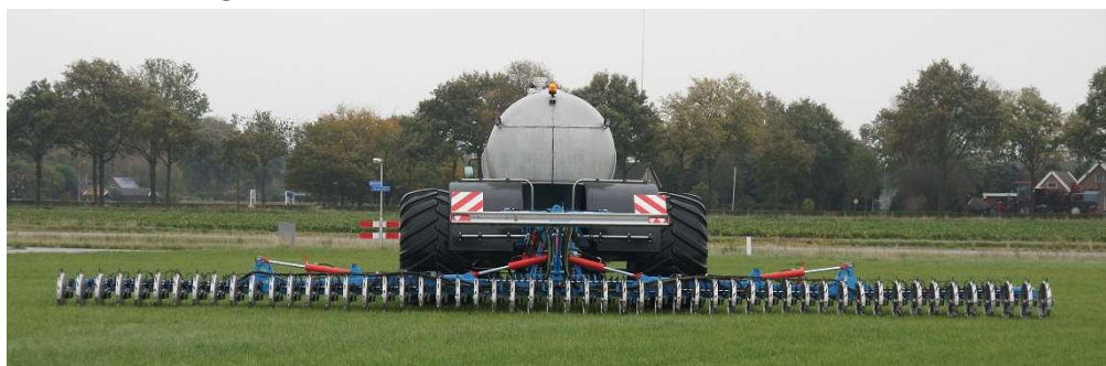
Ликвилайзер: инъектор SW 12048 с насосной бочкой PTW 8500
