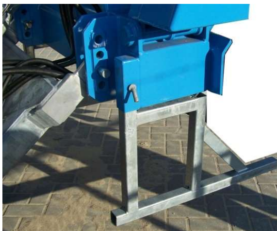
Опорные подставки под инжектором Ликвилайзера
