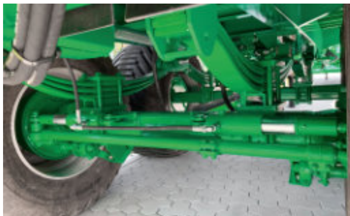
Фото сверху: Опциональная следящая управляемая ось в усиленной версии.
