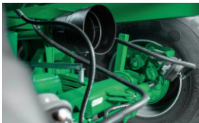
Тяжёлое шасси BPW Boggie с регулятором ALB входит в стандартную комплектацию HS 220.
