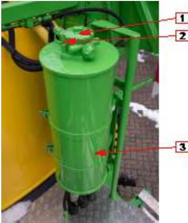
Рис. 108. замена гидравлического масла
