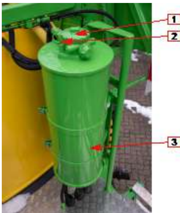
Рис. 112. замена гидравлического масла
