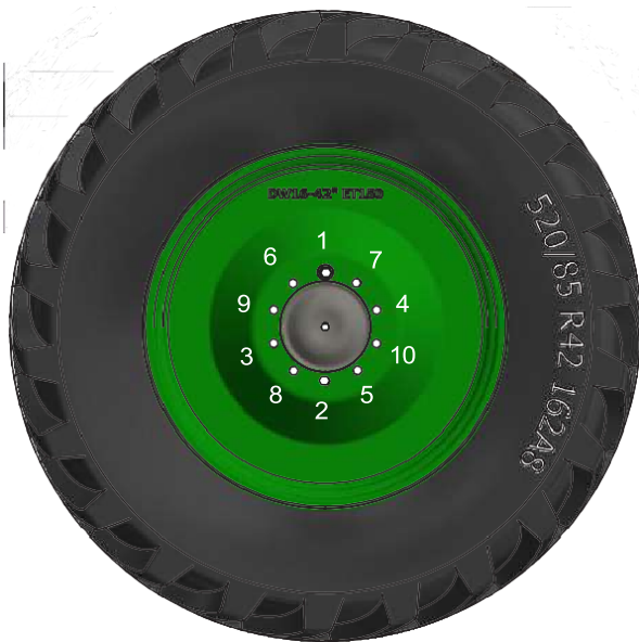
Рис. 131. порядок затяжки колес
