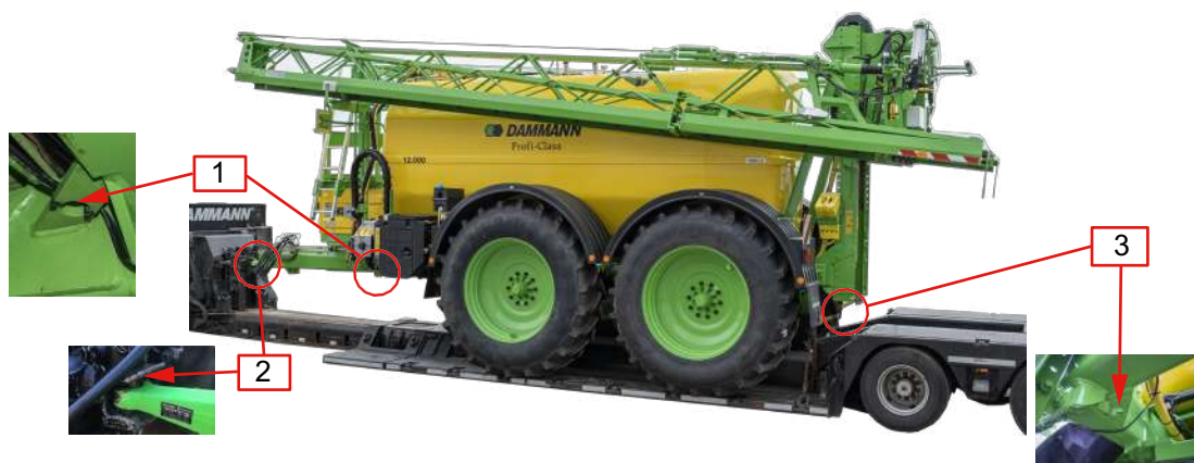
Рис. 54. Крепление на платформенный прицеп с муфтой (пример ANPT)
