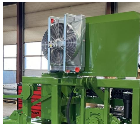
Увеличенный маслоохладитель с автоматическим реверсивным циклом
