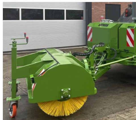
Подметальная щётка 2,25 м с боковой и высотной регулировкой
