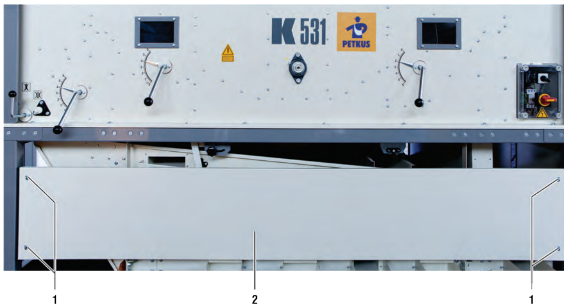
Abb. 33 Демонтаж передней облицовки
