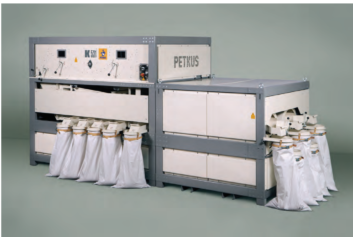
Рис. 4 Общий вид семяочистительно-сортировальной машины К 531
