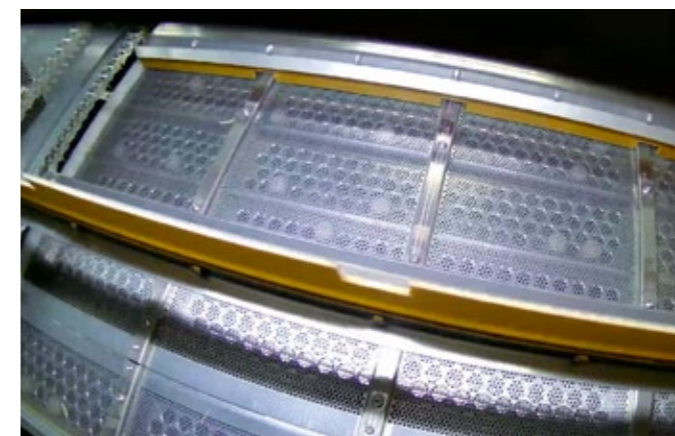
1 Камера в зоне предварительной очистки со скребковым транспортером
