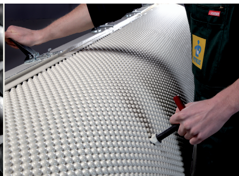
Замки триерного сегмента и транспортные ручки
