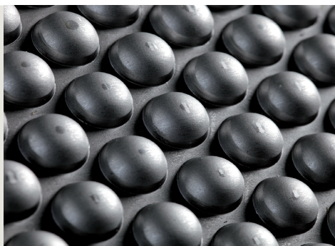
Триерный сегмент с асимметричными ячейками
