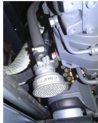
Рис. 17. Удаление воздуха из крышки головки блока цилиндров двигателя.
