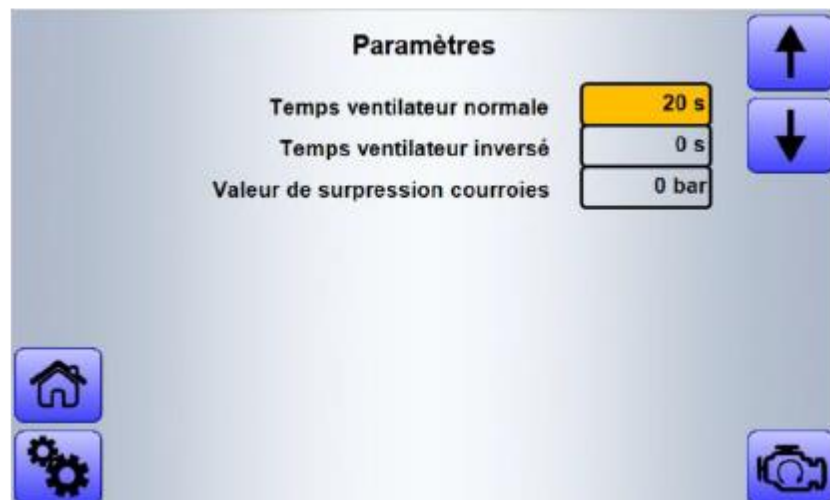
Рис. 16 Параметры охлаждающего вентилятора и давления отрывных ремней
