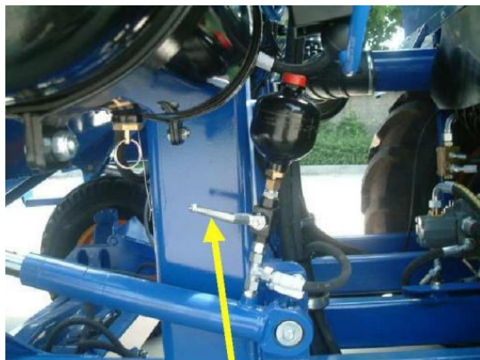
Рис. 7.1 Блокировка механизма теребильного аппарата
